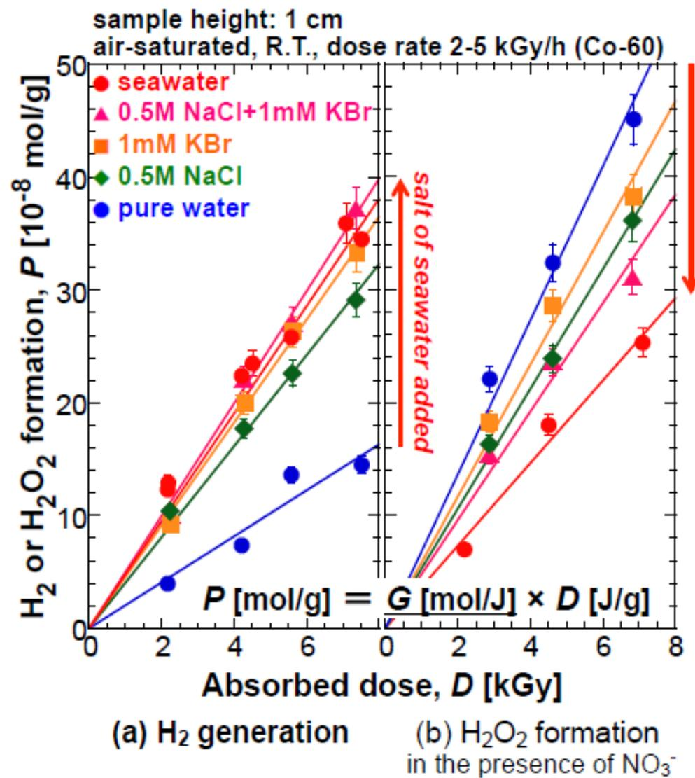
図 8.2-3  $\text{H}_2$  発生(a)及び  $\text{H}_2\text{O}_2$  生成(b)の吸収線量依存性
