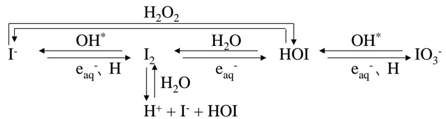
図 7.1.2-3 放射線照射下での水溶液中のヨウ素の反応スキーム
