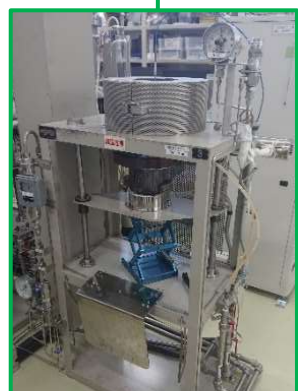
超臨界環境中腐食試験装置 (CBBオートクレープ)
