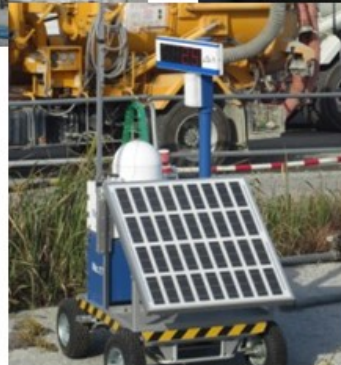
線量計モニター
