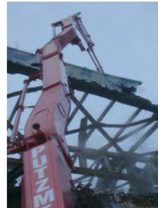
コンクリートポンプ車によるSFPへの注水 (4号機) <sup>1)</sup>
