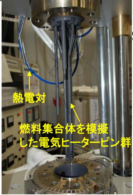
燃料集合体を模擬した電気ヒーターピン群
