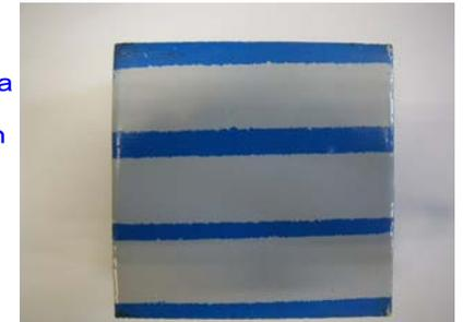
エポキシ塗層(グレー)の上に塗布した水性塗料(青: 固着性汚染模擬)を剥離可能
