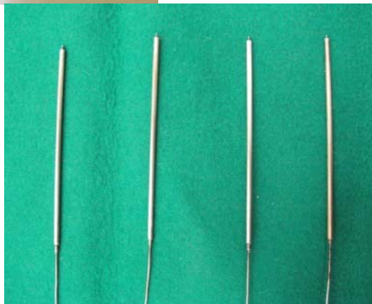
検出器部分 ( \phi 2 \times 100\text{mm} )
