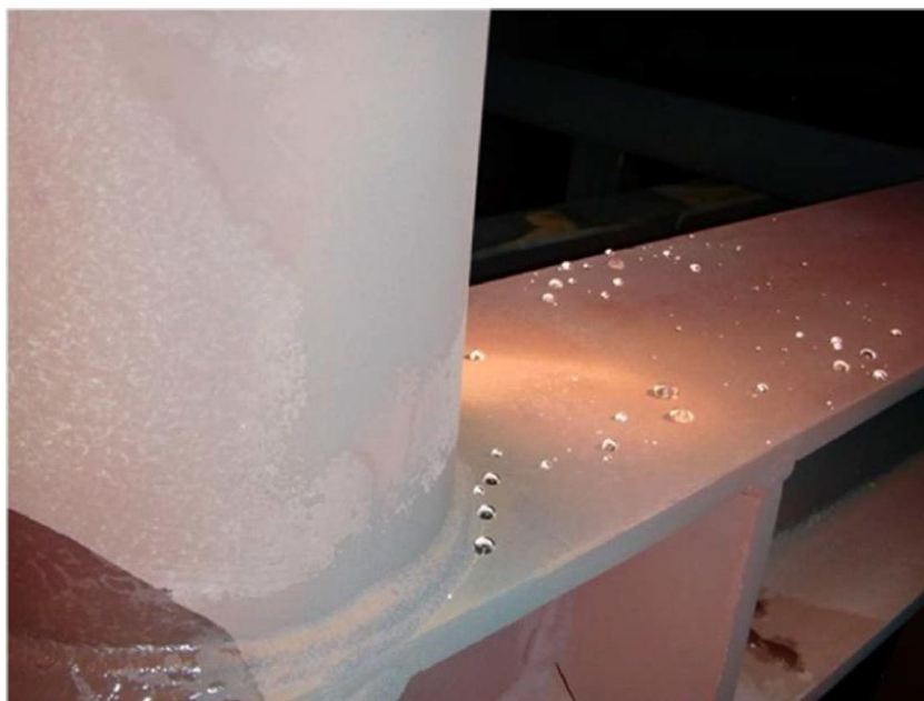
図3.5-1 FFA後復水器表面の撥水 (*1)
