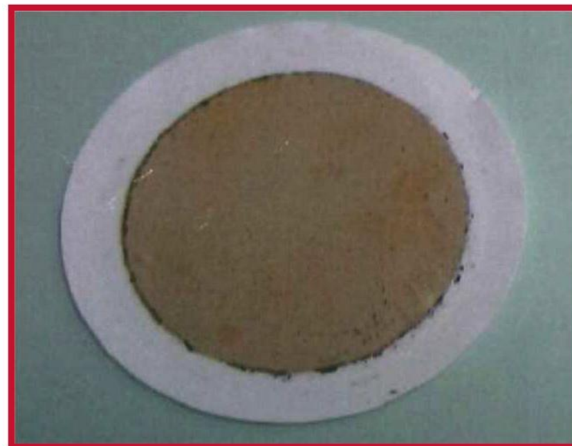
図3.5-2 FFA適用前後での給水鉄のフィルタ捕集外観
