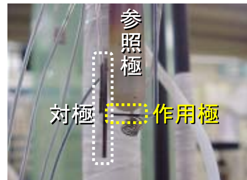
電極近傍の外観写真
