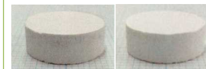
チタン酸塩固化試料 成型圧 : 150 MPa 焼結温度 : 900℃
